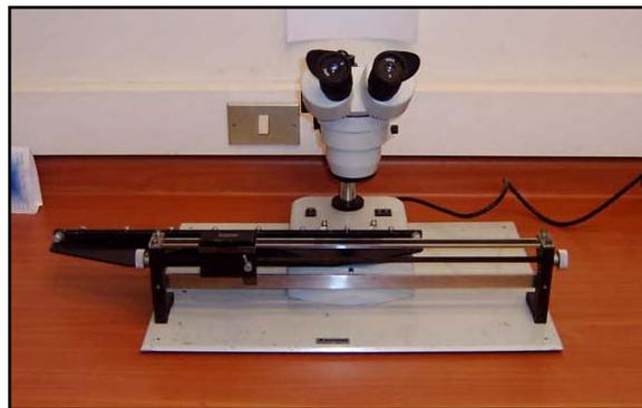
**Figura 4.** Instrumento medidor de tarugos de incremento.
